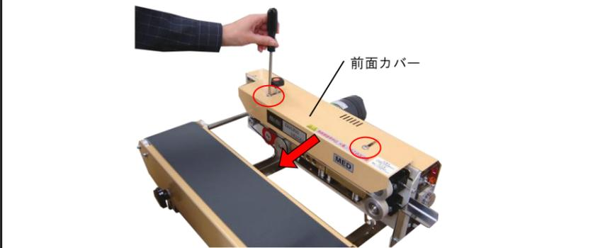
2 上面2ヶ所のネジをゆるめて、前面カバーを手前にスライドさせて取り外します。
